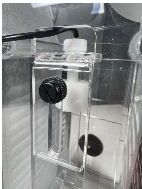
Fig. 2: Montaggio dell'interruttore a galleggiante (regolabile in altezza con una vite)
