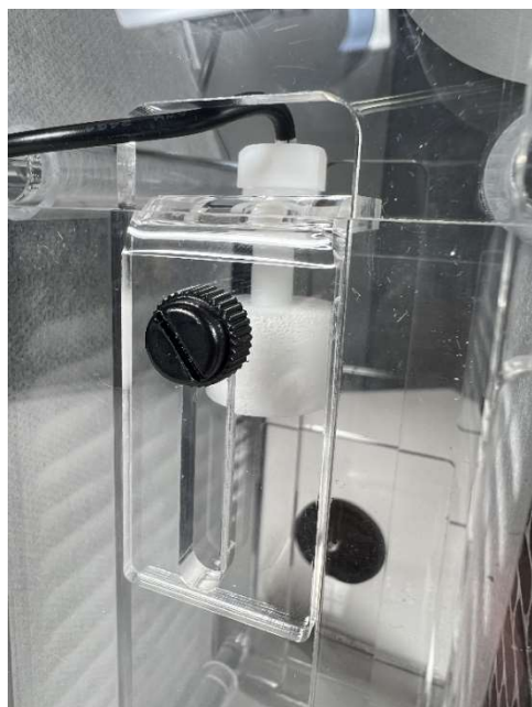
Рис. 2: Монтаж поплавкового выключателя (регулируется по высоте с помощью винта)
