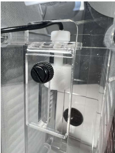
Afb. 2: Vlotterschakelaar monteren (in hoogte verstelbaar met een schroef)
