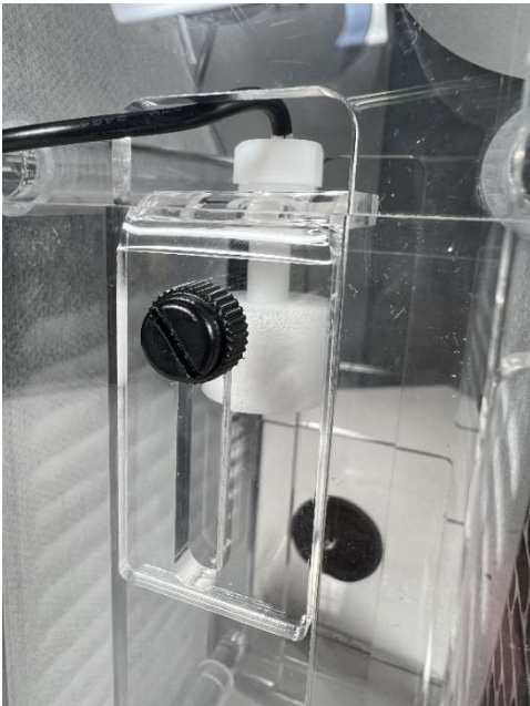
Abb. 2: Montage des Schwimmerschalters (Höhe mittels Schraube einstellbar)
